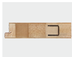
WZMOCNIENIE MASYWNYM CEOWNIKIEM STALOWYM
